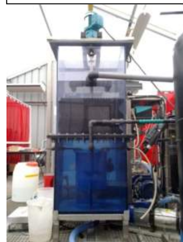
Pilote de production de Struvite et Apatite, STEP de Bruxelles Nord opérée par Aquiris (Veolia)
